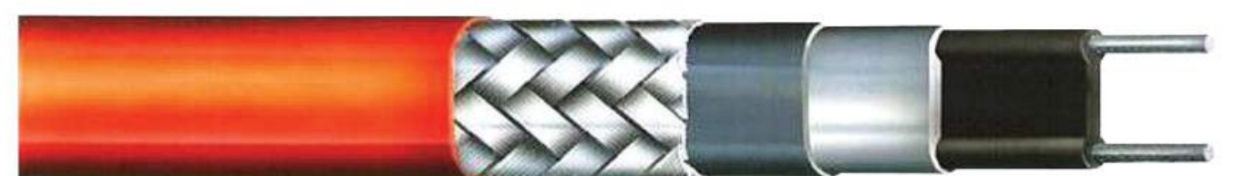
Внешняя защитная оболочка Экранирующая оплетка Полиолефиновая оболочка Внутренняя термопластичная изоляция Полупроводящая матрица Токпроводящие жилы
